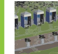
下水道管路上に直接仮設トイレを設ける設備です。下水道に直結しているので汚物を直接流すことができ、滞留・流出に伴う伝染病の発生など、衛生状態の悪化を防げます。
